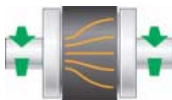
Linien bei gleichmäßiger Belastung an beiden Achsen
